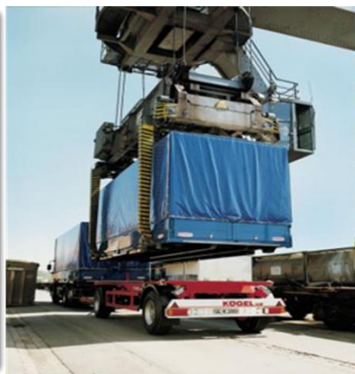
2. 可脱卸箱体吊装
